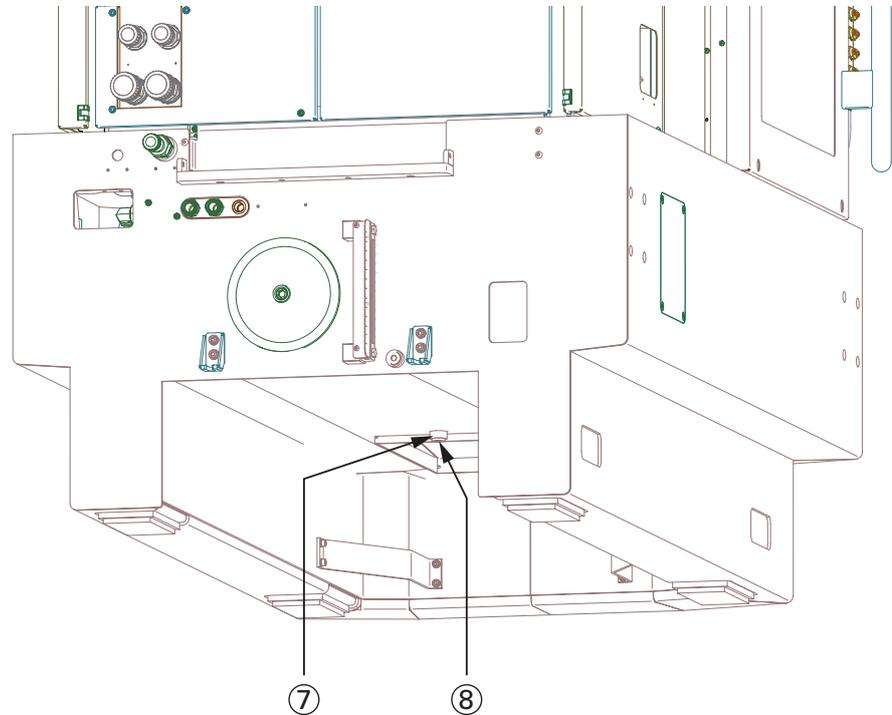
Den Späneförderer bis zum Anschlag in den Unterkasten einschieben.
