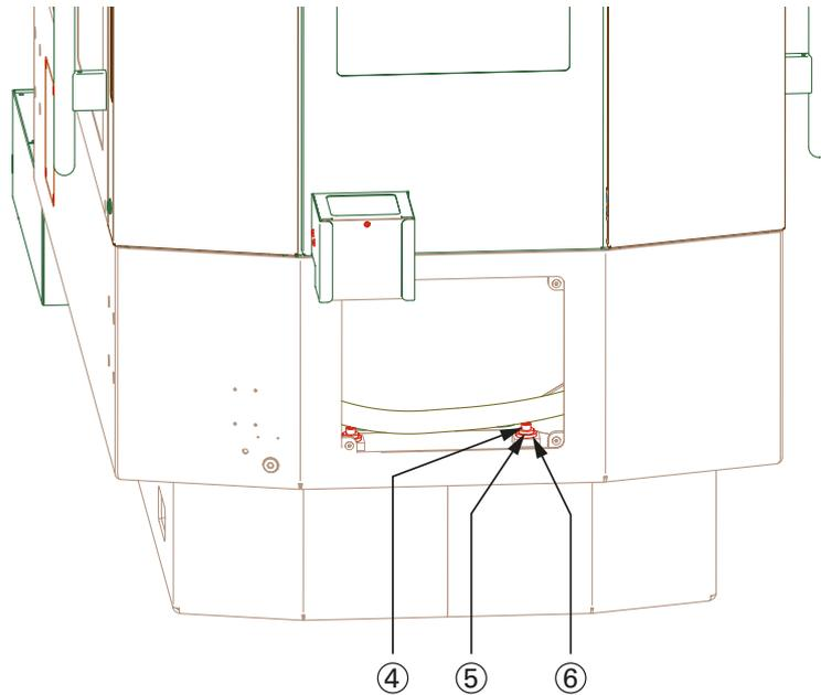
Danach kann der Späneförderer nach links aus dem Unterkasten gezogen werden.
