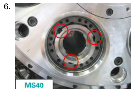
Beispiel: Position Grundkörper MS40
